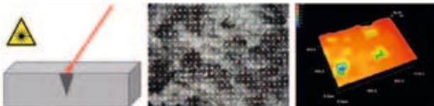
Schema des Laserprozesses, mikroskopische Aufnahme der gelaserten Bodenplatte, Vermessung der gelaserten Löcher (v.l.)
